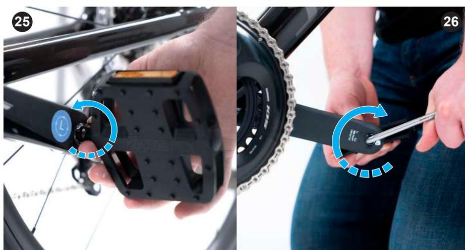
27. **PÉDALES À CLÉ PLATE:** À l'aide de la clé plate, serrer la pédale en place (rotation anti-horaire). Lorsqu'il est au bon couple de serrage, l'outil laisse une impression perceptible de fermeté dans la paume de votre main.
